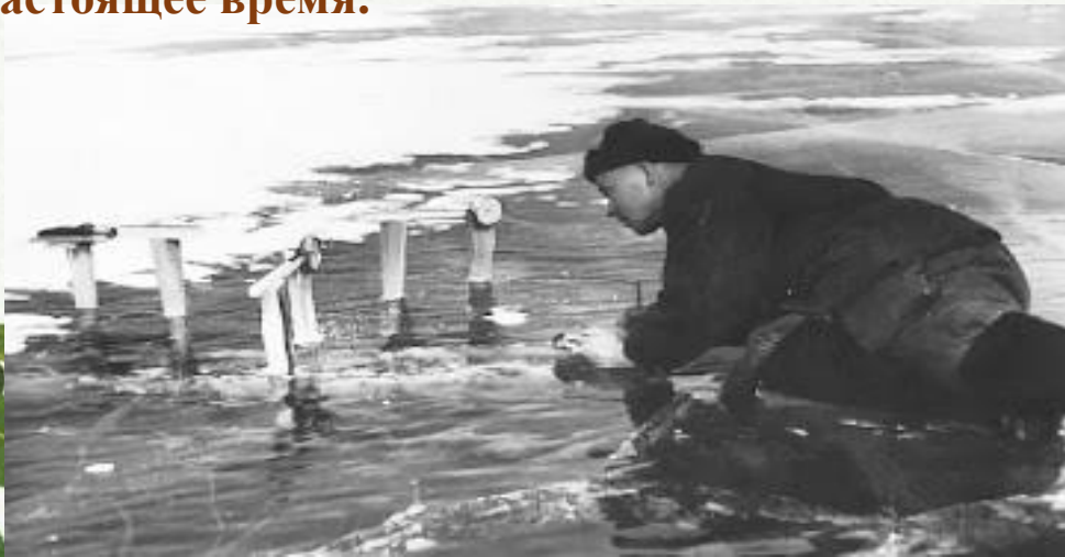
В.М. Сокольников проводит измерение физических характеристик ледяного покрова.
