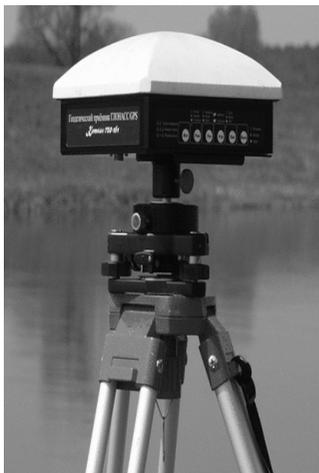
**Рис. 1.10.** Высоточный геодезический прибор «Геодезия», разработанный «Российским институтом радионавигации и времени» (Санкт-Петербург, 2014)
