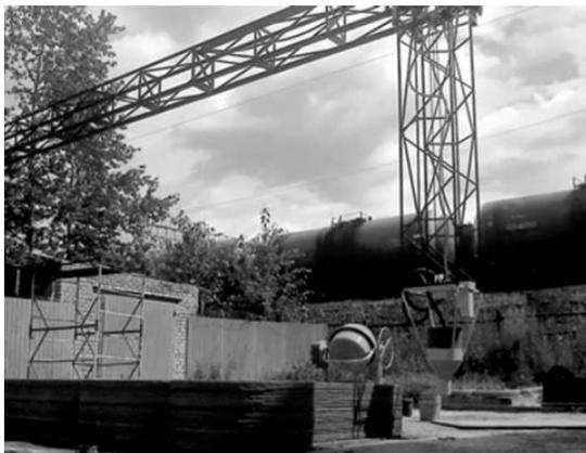
Рис. 2. Принтер строительный трехмерной печати (3d)S-1160
