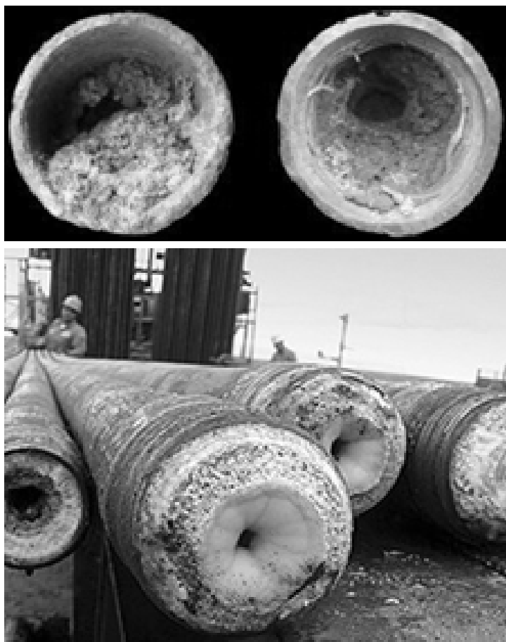
Рис. 1. Образование асфальто-парафиновых отложений на трубах нефтепроводов [22].
