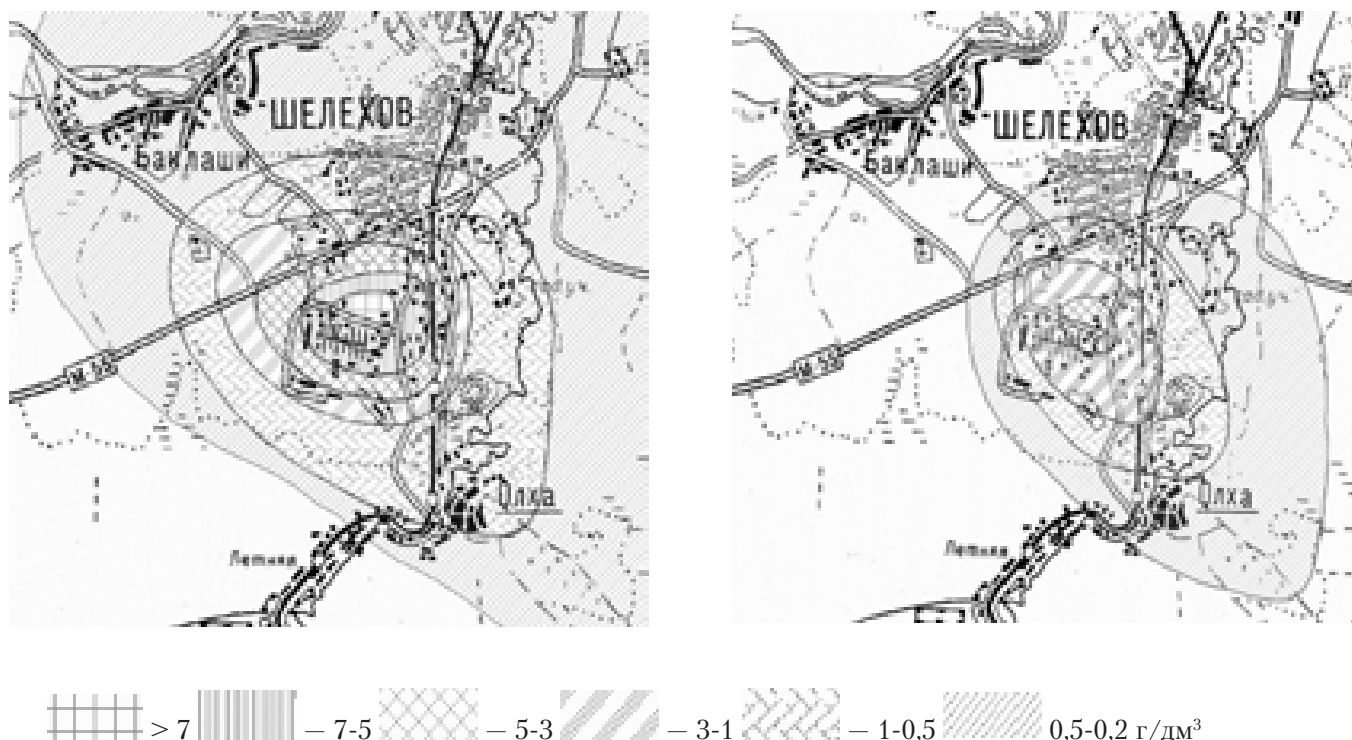
Рис. 1. Содержание твердого вещества в снегу за зимний период 1996 г. (рис. слева) и 2010 г. (рис. справа) в зоне воздействия ИрАЛ, г/дм³.
