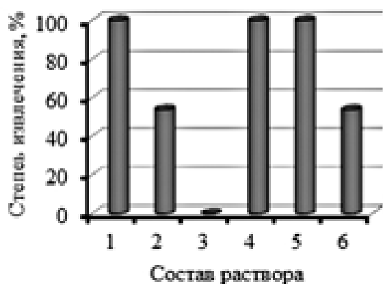
Рис. 5. Степень извлечения мышьяка на марганцевой руде из растворов: 1 – без добавления анионов; при добавлении: 2 – \text{CO}_3^{2-} ; 3 – \text{PO}_4^{2-} ; 4 – \text{Cl}^- ; 5 – \text{SO}_4^{2-} ; 6 – \text{NO}_3^- .
