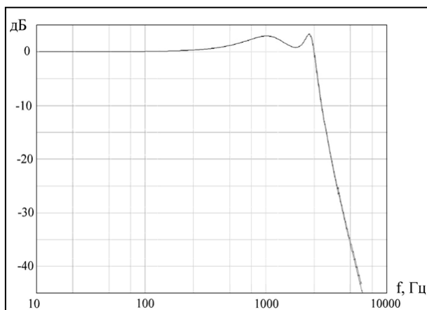
Рис. 4. АЧХ блока подавления зеркальных частот при частоте дискретизации 5 кГц.
