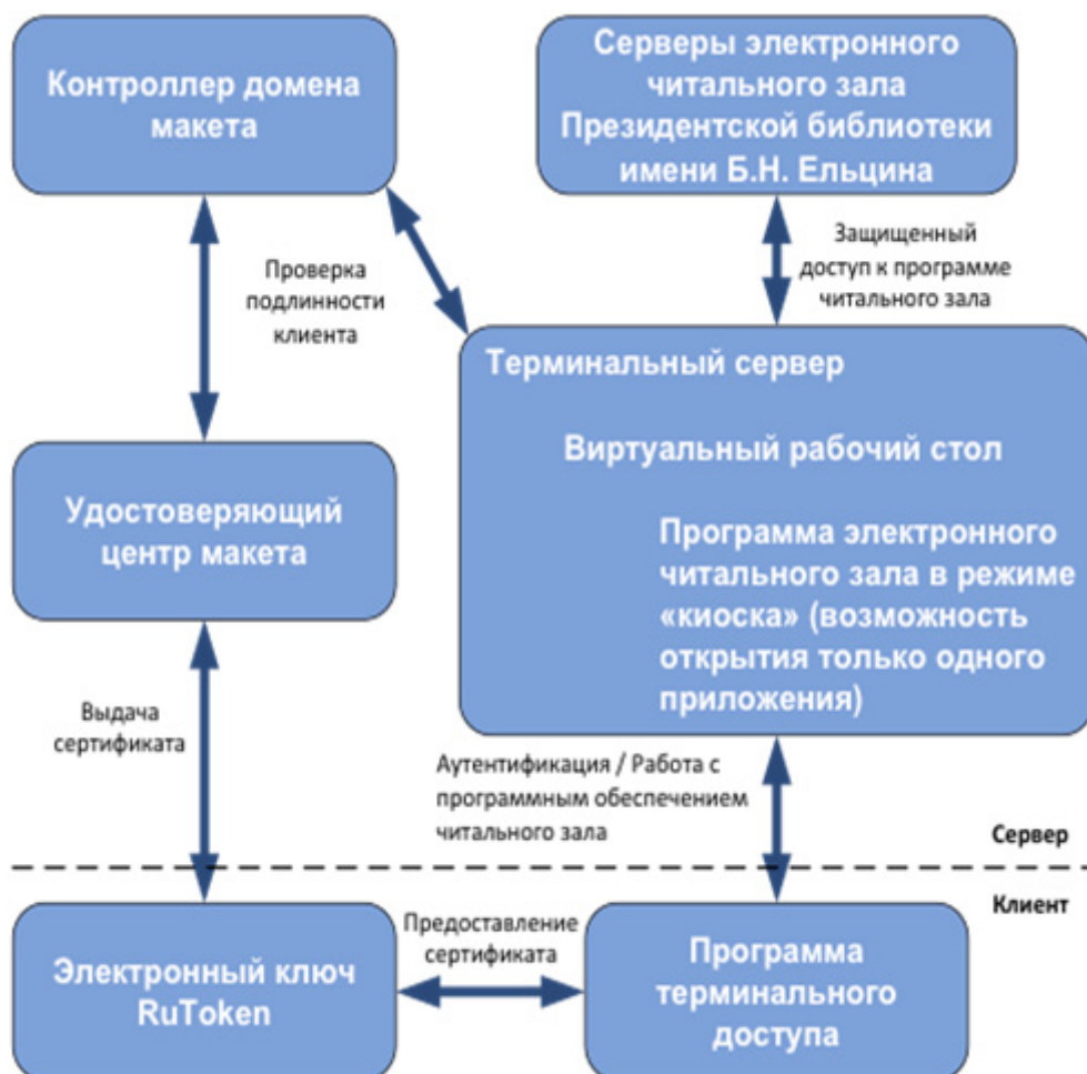
Рис. 2. Алгоритм удаленного доступа
