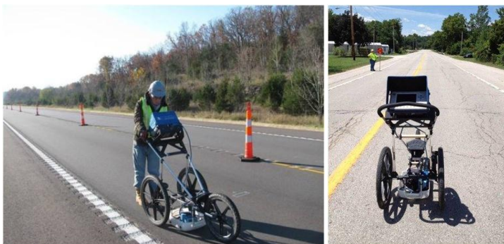
Рис. 1. Иллюстрация принципа работы с георадаром при обследовании дорог [7]
