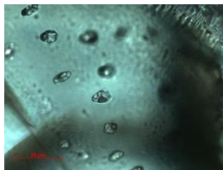
Рис. 2. Флюидные включения в хромдиопсиде
