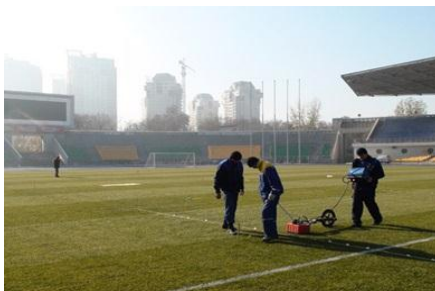
Рис. 1. Использование георадара для картирования подземных коммуникаций на футбольном поле
