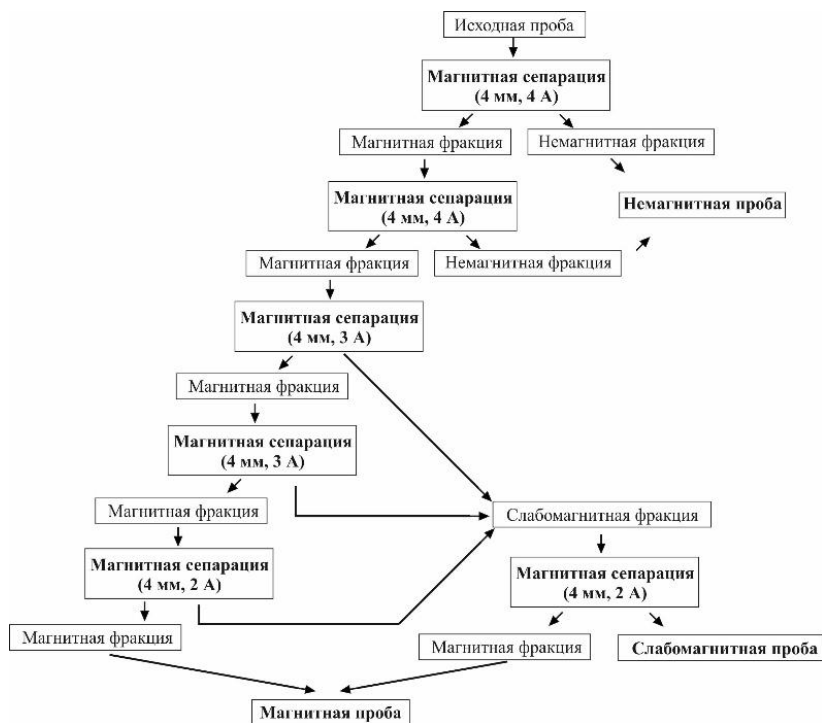
Рис. Схема обогащения гидрогиттитхлоритовых руд методом электромагнитной сепарации
