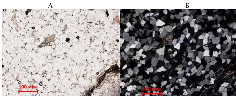
Рис. 2. Алевролит кварцевый с глинистым цементом. Наблюдается трещина, заполненная битуминозным веществом и глинистым цементом (А – параллельные николи, Б – скрещенные николи)
