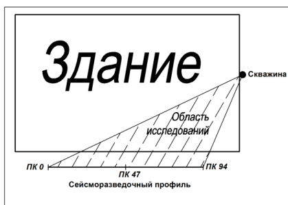
Рис. 1. Схема проведения сейсмического просвечивания
