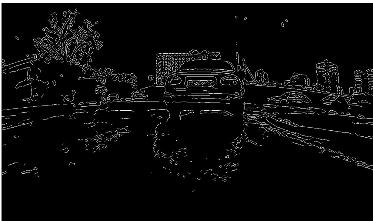
Рис. 3. Участок дороги на рис. 1 после обработки детектором Канни
