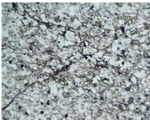
Рис. 1. Обр.1С-9.0 м. Метапесчаник, текстура микрослоистая, структура псаммитовая; признаки бластогенеза: глинисто-слюдястый цемент превратился в мусковит, биотит и хлорит, трещина заполнена гранобластами эпидота, кальцита и кварца; признаки катаклаза: микротрещины с агрегатным эпидотом и чешуйками биотита; R_{пр}=2.74 ; R_p=30.6 ; R=132.3 ; Кан ( R/R_p )=4.3; K_{рА} , K_{рБ}=0.61–0.67 .
