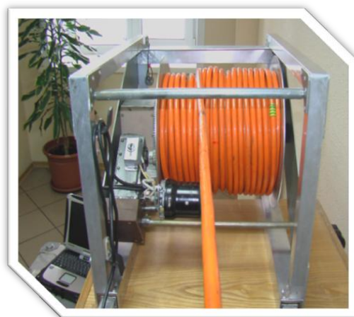
Рис.3. Лебедка каротажная (вид спереди) [6]
