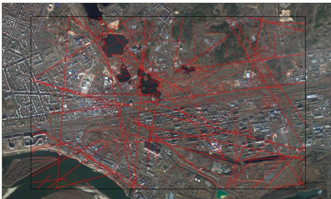
Рис.1. Карта тектонической трещиноватости восточной промзоны г. Дзержинска (И.С. Копылов, 2015)
