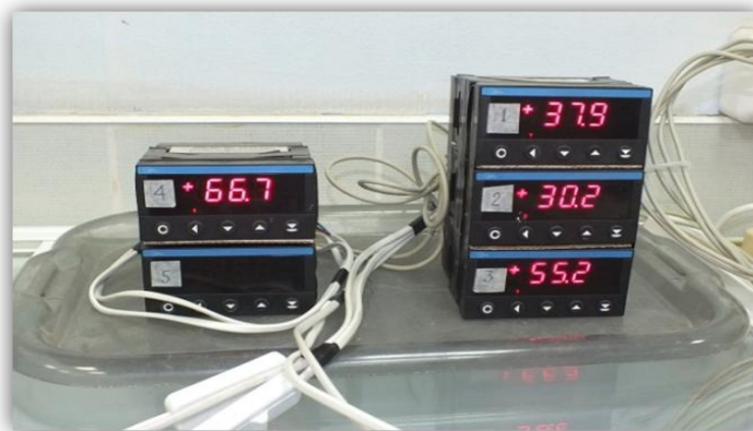
Рис.2. Устройство для измерения вертикальных деформаций грунта
