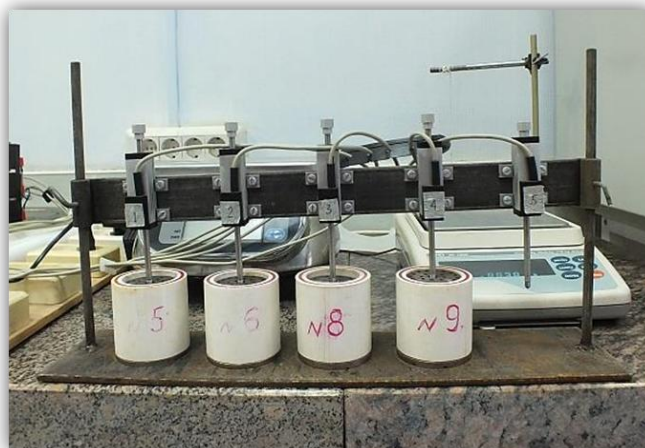
Рис.1. Прибор для нагружения образцов грунта, образцы грунта в обойме
