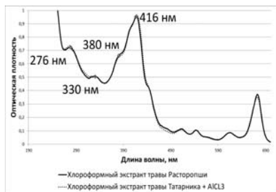
Рис. 3. Спектральные характеристики хлороформного экстракта травы расторопши пятнистой: А – батохромный сдвиг при добавлении комплексообразователя ( \text{AlCl}_3 ), Б – дифференциальная кривая.
