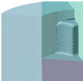
Рис. 12. Выдавливание металла в зазор между матрицей и пуансоном
