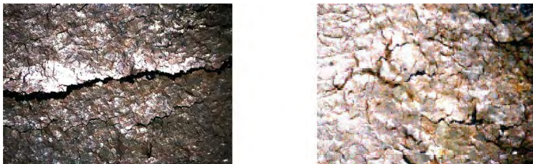
Рис. 2. Поверхность разрушенного слитка послековки, \times 10
