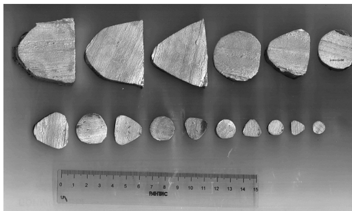
Рис. 1. Темплеты деформированных полуфабрикатов по проходам прокатки
