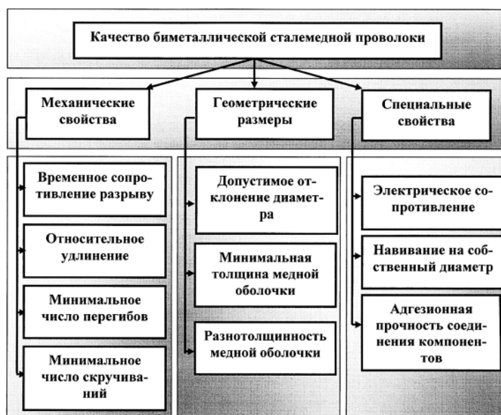
Рис. 1. Структура качества сталемедной проволоки
