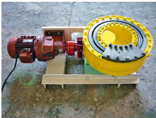
Рис. 3. Фотография экспериментальной установки непрерывного литья в карусельный кристаллизатор и прессования способом Конформ
