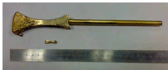
Рис. 6. Недокаты и пресс-изделия, полученные методом совмещенной обработки сплава ПСр-40 на различных экспериментальных установках
