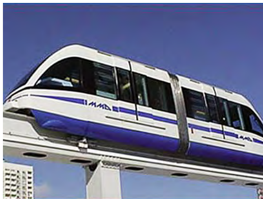
Рис. 4. Подвижной состав монорельсовой транспортной системы с дверными створками из алюминиевых сплавов
