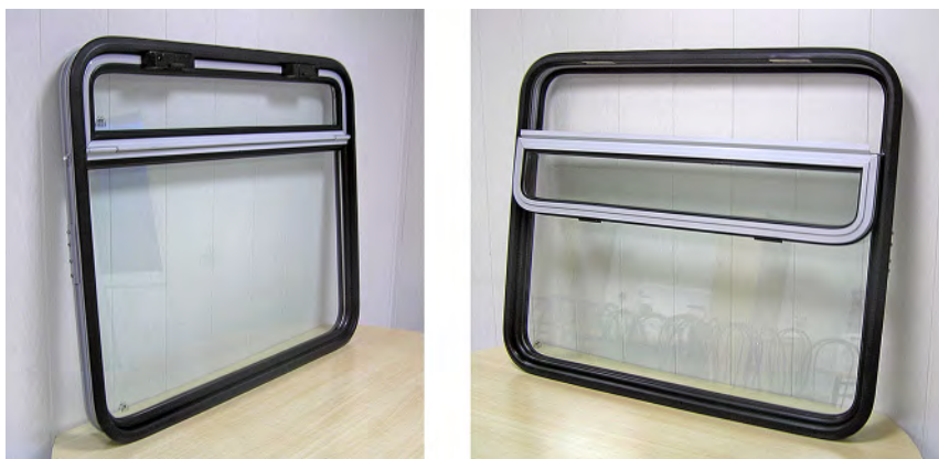
Рис. 1. Алюмопластиковый оконный блок пассажирского вагона а – в закрытом положении; в – с открытой форточкой
