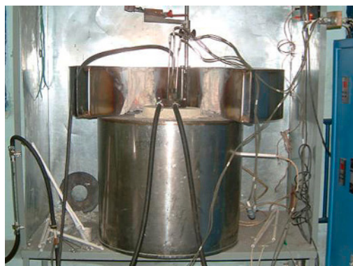
Рис. 6. Экспериментальная ячейка для оценки стойкости теплоизоляционных материалов к газообразным компонентам
