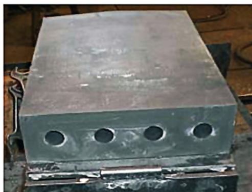
Рис. 8. Стенд для вибропрессования смачиваемых катодов на 5 кА (а) и вид зеленого (отпрессованного, но необожженного) катода (б)
