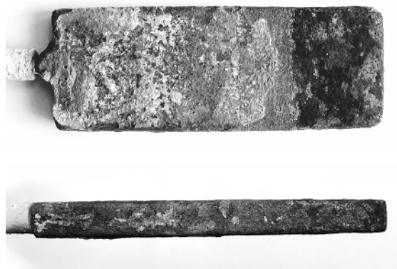
Рис. 4. Внешний вид анода Cu-Fe(32)-Ni(20), масс. % после электролиза, \tau = 196 ч.
