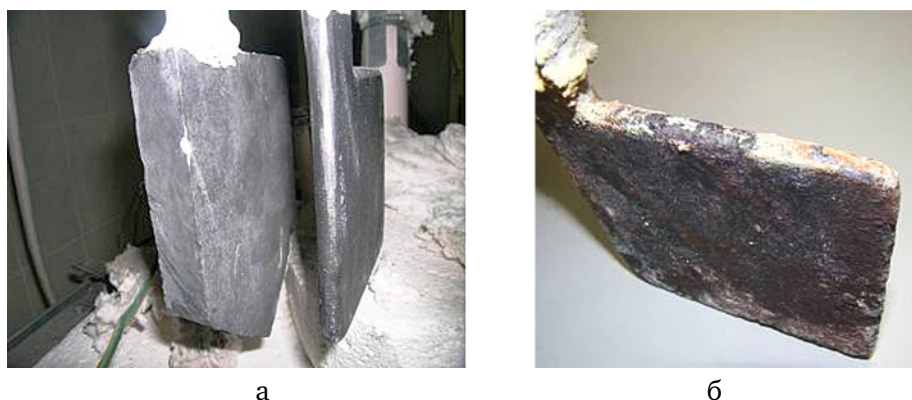
Рис. 4. Внешний вид анодно-катодной сборки до испытаний (а) и внешний вид анода после испытаний (б)
