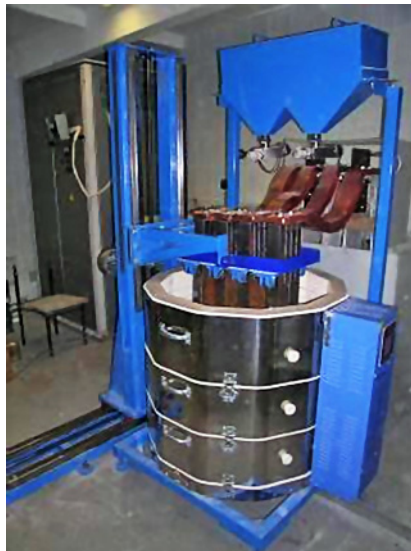
Рис. 2. Внешний вид крупнолабораторного электролизера на 5 кА для испытания инертных анодов
