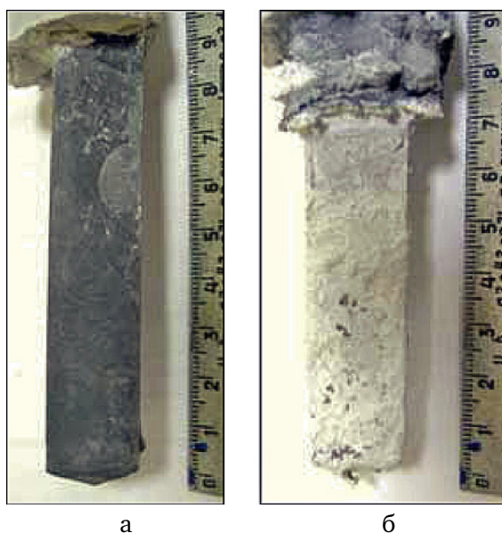
Рис. 6. Внешний вид композиционных катодов на основе диборида титана до (а) и после (б) ресурсных испытаний в криолит-глиноземном расплаве
