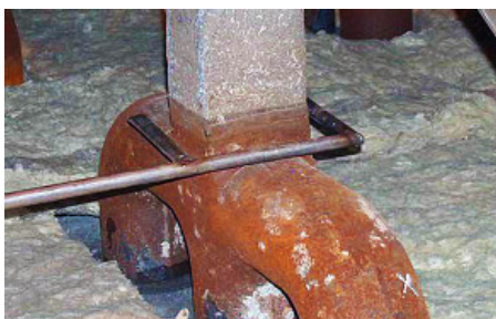
Рис. 7. Устройство охлаждения для биметаллического соединения, установленного на анод при сухом запуске (из работы [97])
