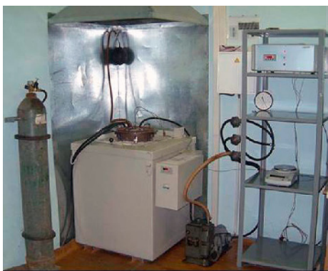
Рис. 5. Установка для испытаний на криолитоустойчивость барьерных материалов
