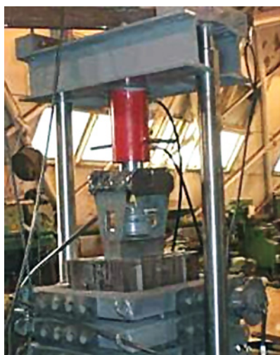
Рис. 8. Стенд для вибропрессования смачиваемых катодов на 5 кА (а) и вид зеленого (отпрессованного, но необожженного) катода (б)
