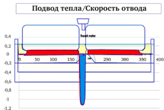
Рис. 1. Масштабное представление потребности/расхода тепловой энергии на поперечном разрезе электролизера
