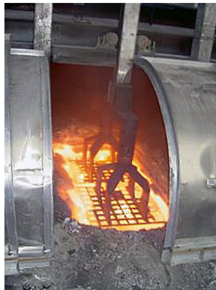
Рис. 9. Испытание металлического инертного анода на промышленном электролизере Красноярского алюминиевого завода
