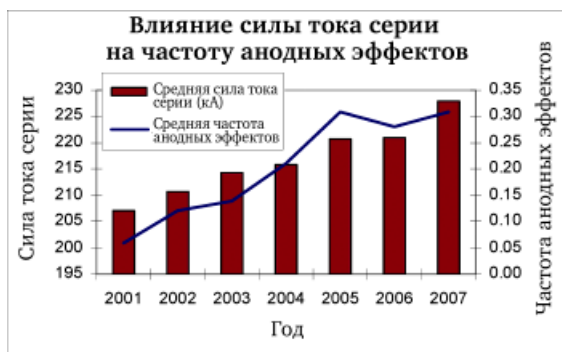
Рис. 2. Зависимость увеличения частоты анодных эффектов от силы тока серии без поправок для улучшения растворимости
