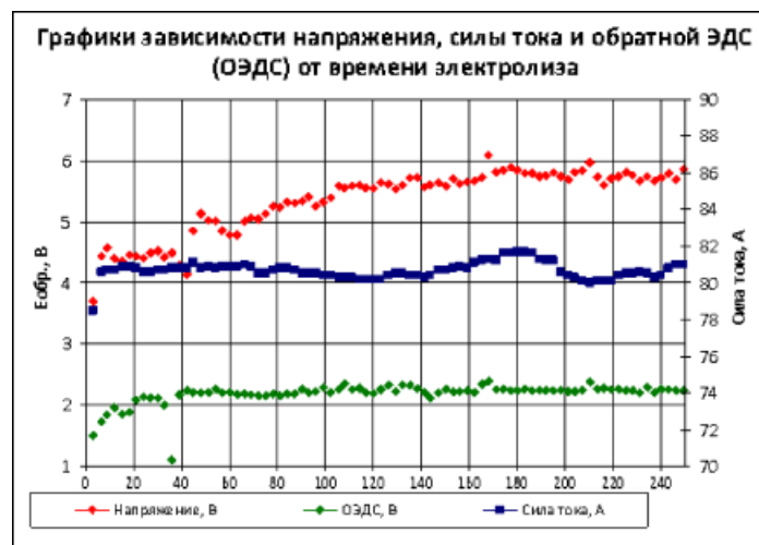
Рис. 3. Зависимости напряжения, силы тока и обратной ЭДС от времени в ходе ресурсных испытаний металлического анода Cu-Fe-Ni в криолит-глиноземном расплаве.
