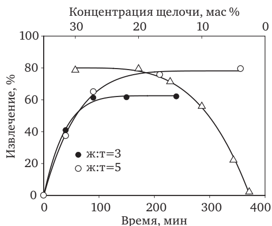
Рис. 2. Зависимость степени извлечения цинка при температуре 200^\circ\text{C} от концентрации щелочи при ж:т = 5 и от соотношения ж:т фаз при концентрации щелочи 20 мас%
