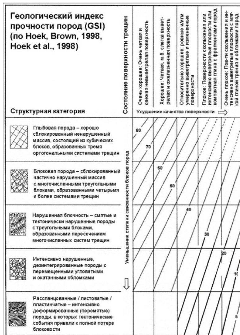
Рис. 1. Характеристика геомеханического состояния горных массивов на основе блочности строения и характера изменения (выветрелости) плоскостей трещин
