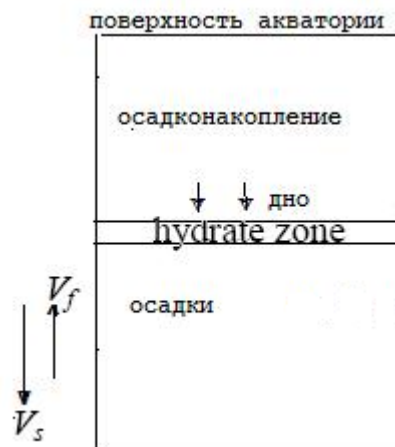
Рисунок 1. Схема положения зоны стабильности газовых гидратов в морских осадках и стрелками показаны процессы осадконакопления и погружения осадков и фильтрации к поверхности поровых флюидов, содержащих растворенный газ.
