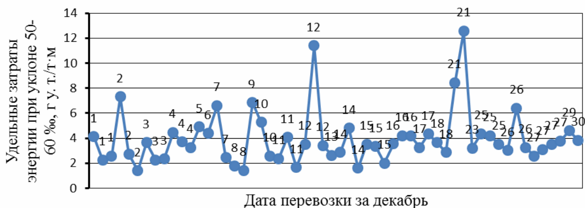
Рис. 2. График удельных затрат энергии автосамосвала БелАЗ-75131 №1207 при уклоне 50-60‰
