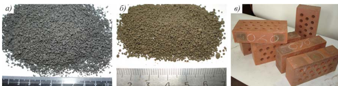
Рис. 1. Выпуск керамического кирпича на основе углистых аргиллитов: а) гранулированная шихта состава 100% отходов; б) тоже, покрытых слоем глинистой добавки 15%; в) кирпич формата 1 НФ с 17 цилиндрическими отверстиями.
