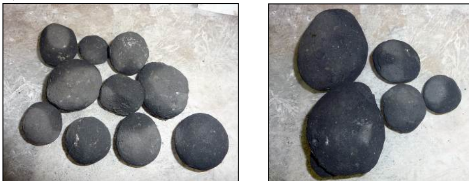
Рис. 2. Получаемые топливные гранулы различного состава и свойств
