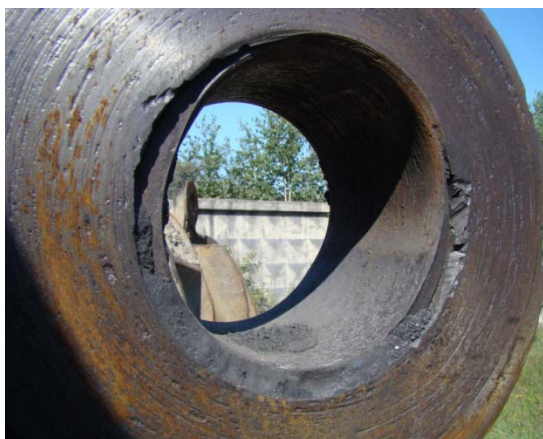
Рис. 3 Втулка бронзовая ковша экскаватора ЭКГ-10 изношенная вследствие адгезионного износа
