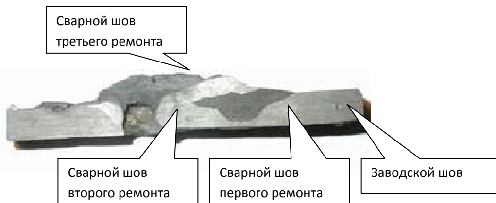
Рис. 1 Поперечное сечение ремонтного сварного шва
