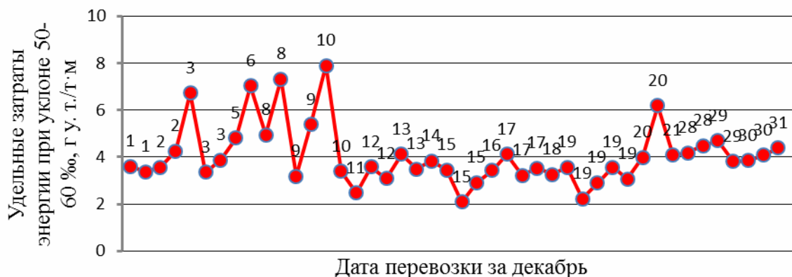
Рис. 3. График удельных затрат энергии автосамосвала БелАЗ-75131 №1345 при уклоне 50-60%
