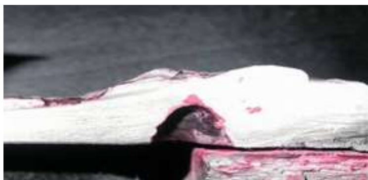
Рис. 2 Капиллярный контроль ремонтного сварного шва
