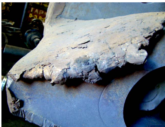
Рис. 4 Изношенное в результате ударных нагрузок колесо, ведущее экскаватора ЭКГ-5
