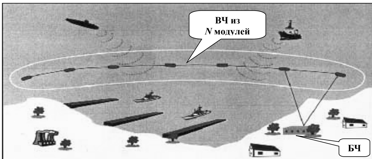
Рис.2. Схема функционирования гидроакустической системы «Вектор»
