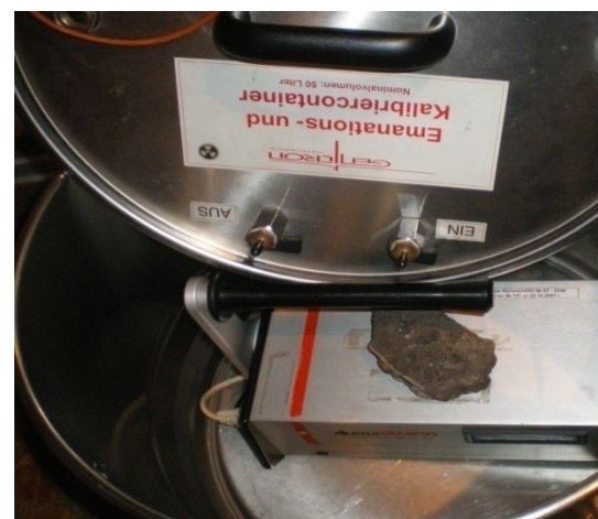
Рис. 5. Лабораторная установка для эманационных испытаний
