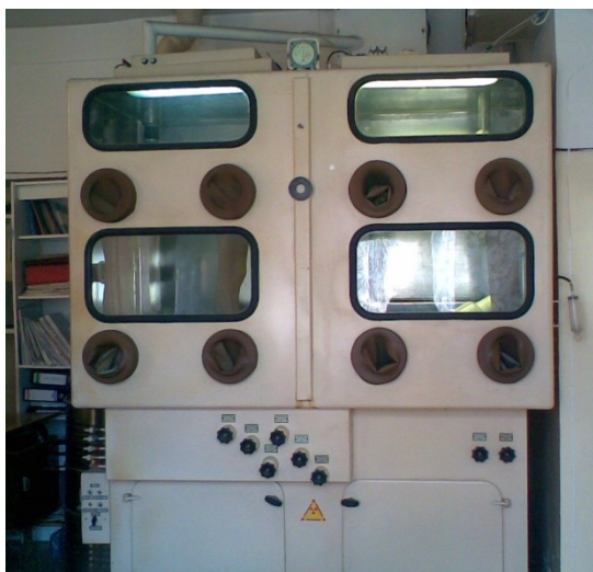
Рис. 1. Внешний вид эманационного контейнера и положение прибора при проведении эксперимента по изучению влияния влажности на вариации МД гамма-излучения (г. Красноярск, ул. Сопочная, д. 38)
