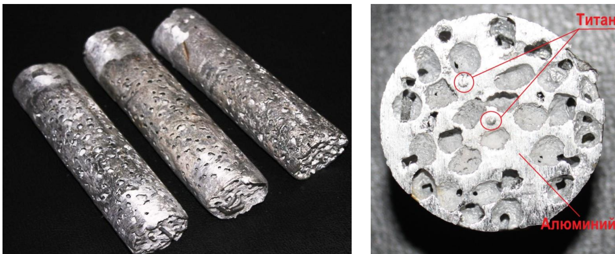
Рис.2. Внешний вид образцов пеноалюминия армированного титановой проволокой.
