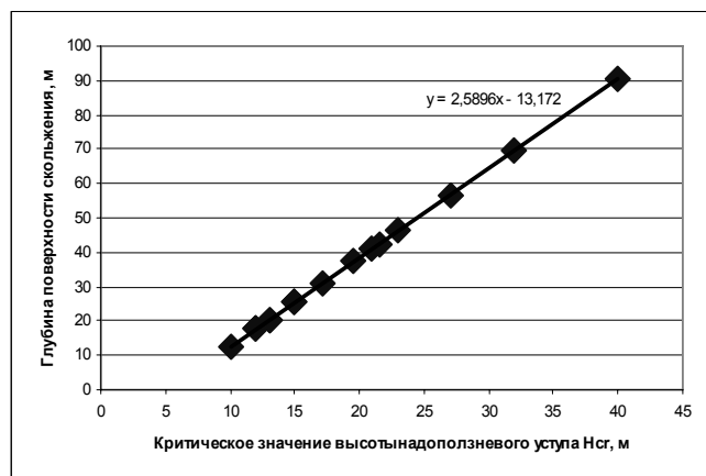
Рис. 2. Зависимость глубины залегания поверхности скольжения от H_{кр} для глубоких оползней Москвы
