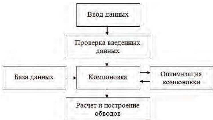
Рисунок 2 — Структура программного обеспечения для автоматизированного процесса формирования обводов фюзеляжа
