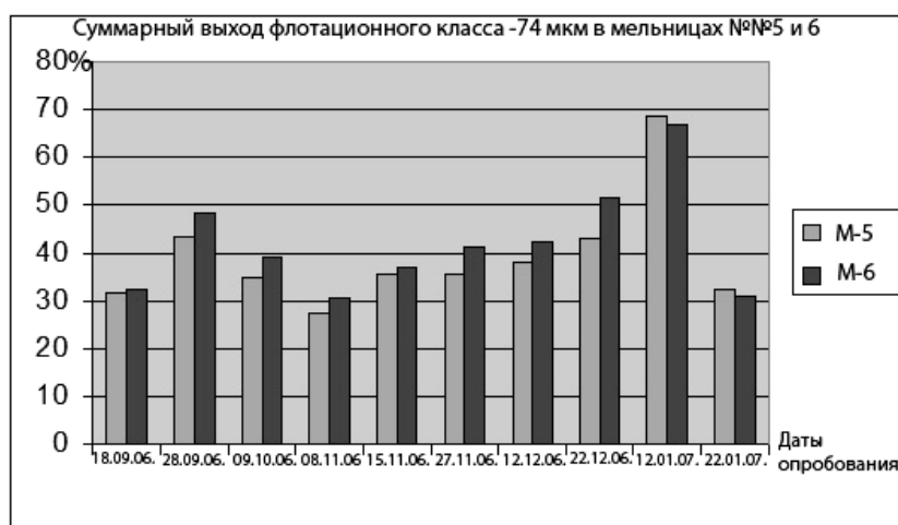
Рис. 4. Динамика выхода флотационных классов в разгрузке мельниц № 5 и 6 за период испытаний шаров.
