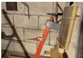
Рис.3. Проведение испытаний на устойчивость к пробиванию топором ударостойкого щитка
