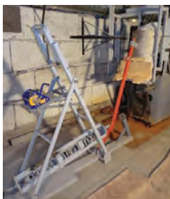
Рис.1. Общий вид конструкции оборудования для проведения испытаний на стойкость к удару топором
