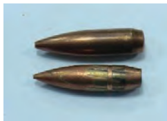
Рис. 3. Поверхность цилиндрической части пули до и после движения по каналу ствола оружия
