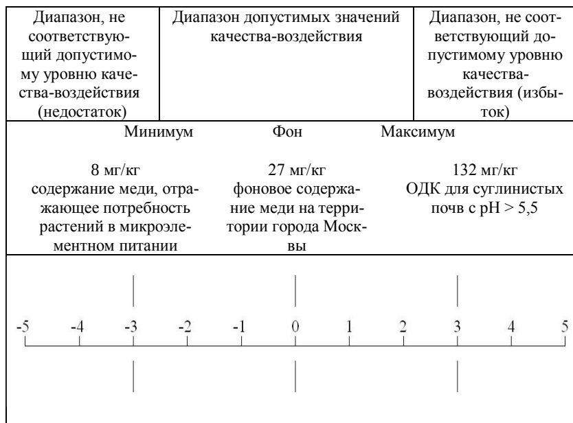
Рис. 2. Принципиальная схема экологической оценки и регулирования качества почв и воздействия на них в абсолютных и относительных показателях (на примере меди)
