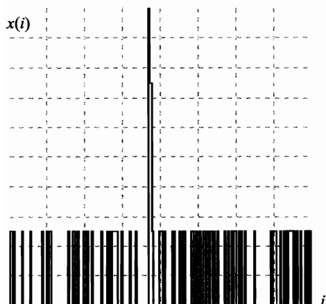
Рис. 2.23. Нормированный тестовый сигнал, искаженный импульсным шумом и случайным сдвигом
