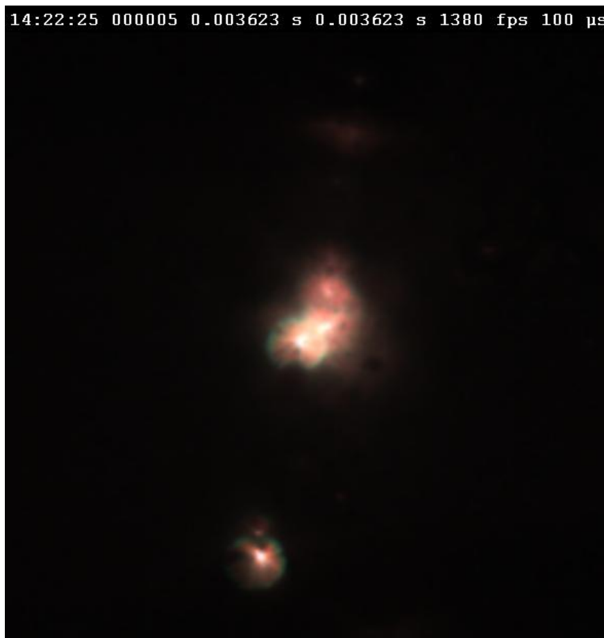
Рис.4. Скоростная визуализация процесса пробоя пузырька с газом
