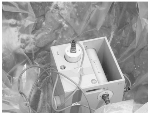
Индукционный магнитометр для измерения вариаций и микропульсаций геомагнитного и геоэлектрического полей
