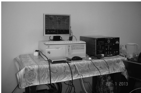
Радиотомографический приемник сигналов искусственных спутников Земли на частотах 400 и 150 МГц для изучения ионосферных полей
