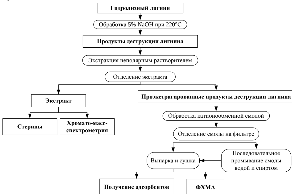
Схема 1. Обработка гидролизного лигнина перед получением прекурсоров с полиакриламидом
