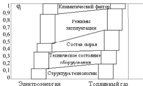
Рис. 2. Влияние факторов на потенциал повышения энергетической эффективности топливной и электротехнической подсистем
