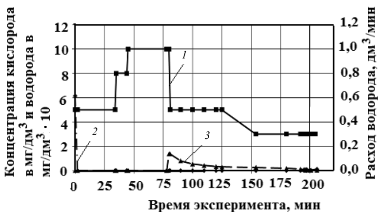
Рис. 4. Зависимость расхода водорода, концентрации кислорода в фильтрате, \text{мг/дм}^3 и остаточной концентрации водорода в фильтрате от времени проведения эксперимента: 1 — расход водорода, \text{дм}^3/\text{мин} ; 2 — концентрация кислорода в фильтрате, \text{мг/дм}^3 ; 3 — остаточная концентрация водорода в фильтрате, \text{мг/дм}^3
