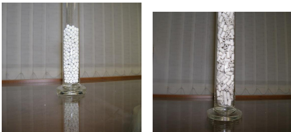
Рис.7. Сравнение укладок шариковых КС-278 (средний диаметр 6 мм) – слева и трубчатых КТ-1-СН (6 x 4 x 10 мм) – справа катализаторов в трубке диаметром 25 мм.
