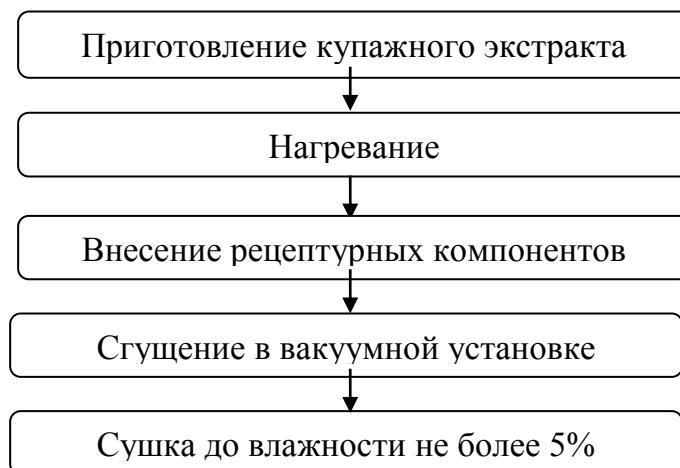
Рис. 3. Технологическая схема производства КПСП
