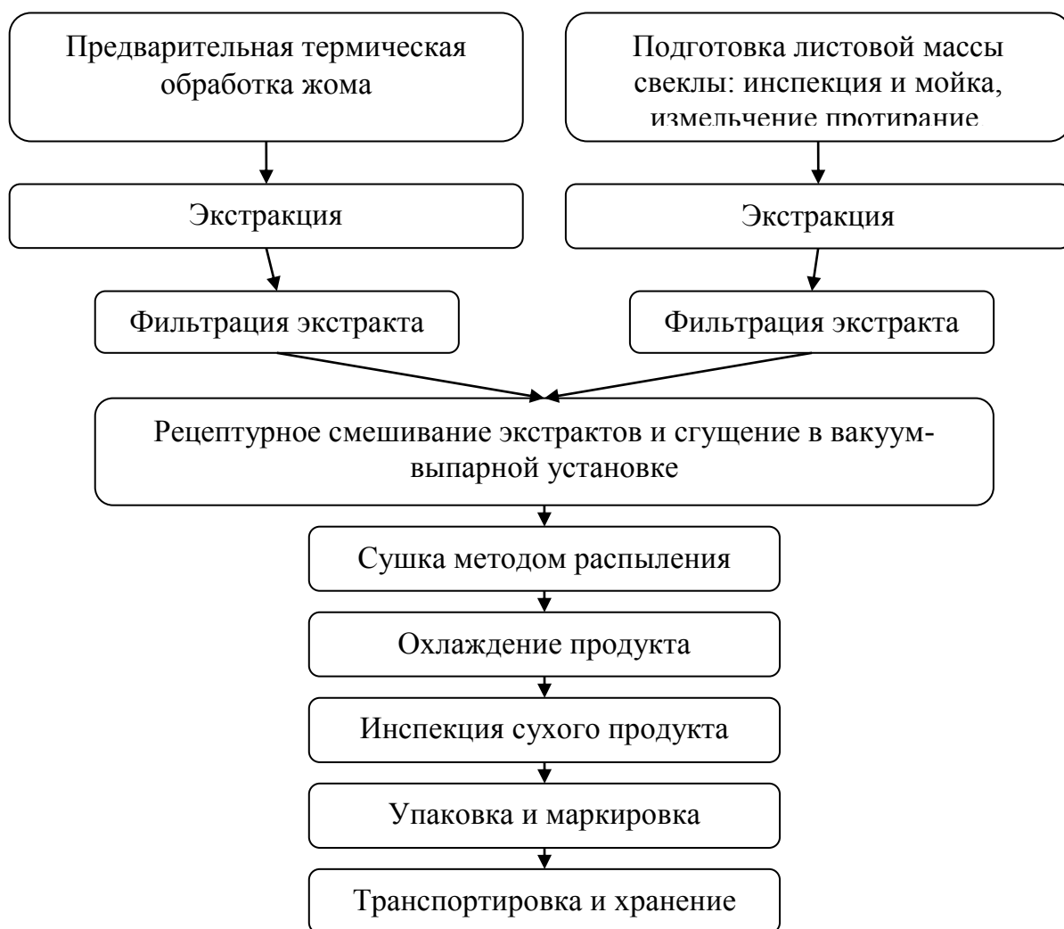
Рис. 2. Структурная схема производства КПС
