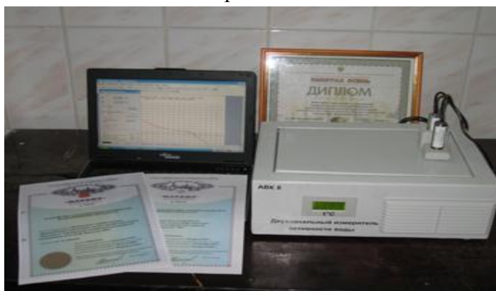
Рис. 1. Двухканальный анализатор активности воды АWK-8
