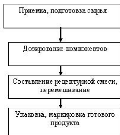
Рис.1. Структурная схема производства сухих смесей для лечения и профилактики метаболического синдрома.
