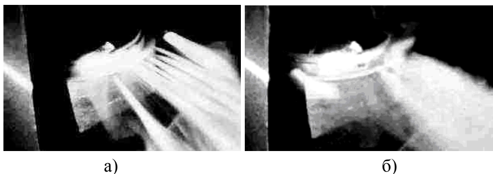
Рис. 2. Визуализация структуры газового потока в начальный момент открывания клапана: а) режим многоструйного истечения при расходе воздуха \leq 4 л/мин; б) режим возбуждения автоколебаний рабочей пластины при расходе воздуха \approx 6 л/мин
