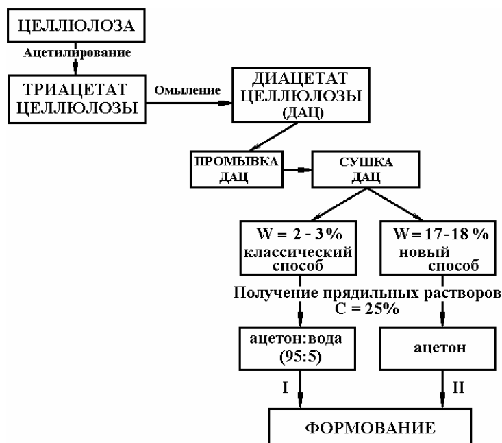
Рис. 1. Обобщенная технологическая схема получения ацетатцеллюлозных волокон
