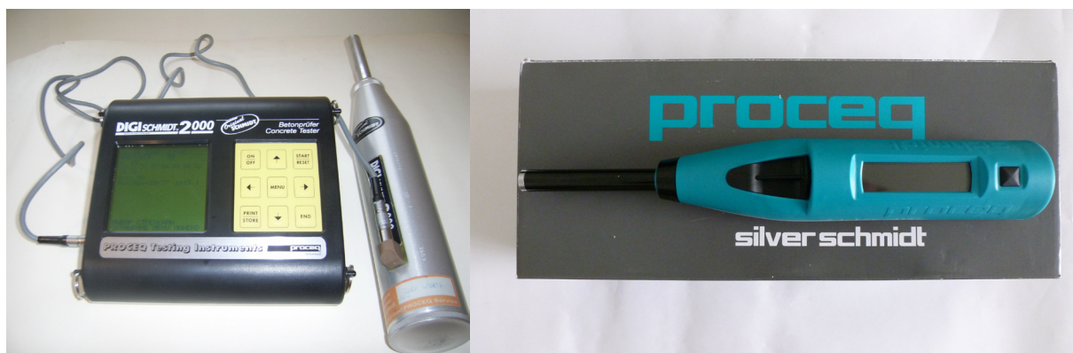
Рис. 3. Общий вид измерительных приборов DIGI – SCHMDT 2000 и Silver SCHMIDT.
