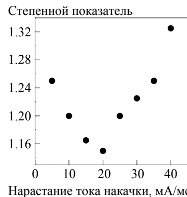
Рис. 9. Показатель степени n в соотношении (1) как функция параметра нарастания тока накачки в течение импульса
