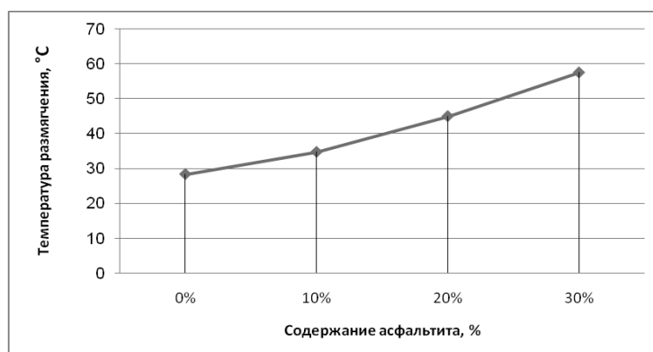
Рис. 4. Изменение температуры размягчения деасфальтенизата гудрона в зависимости от содержания в нем асфальтита.
