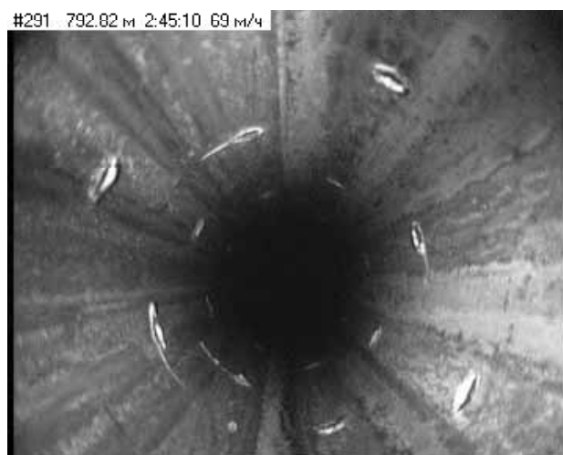
Рис 3. Визуальное изображение кумулятивной перфорации в эксплуатационной колонне.
