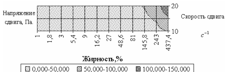
Рис. 2. Зависимость напряжения сдвига \tau от жирности Ж и скорости сдвига \dot{\gamma} при фиксированной температуре T = 31^\circ\text{C}
