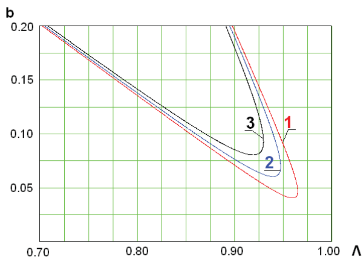
Рис.5. Области устойчивости и неустойчивости положения равновесия 1 – добротность 100, 2 – добротность 70, 3 – добротность 50
