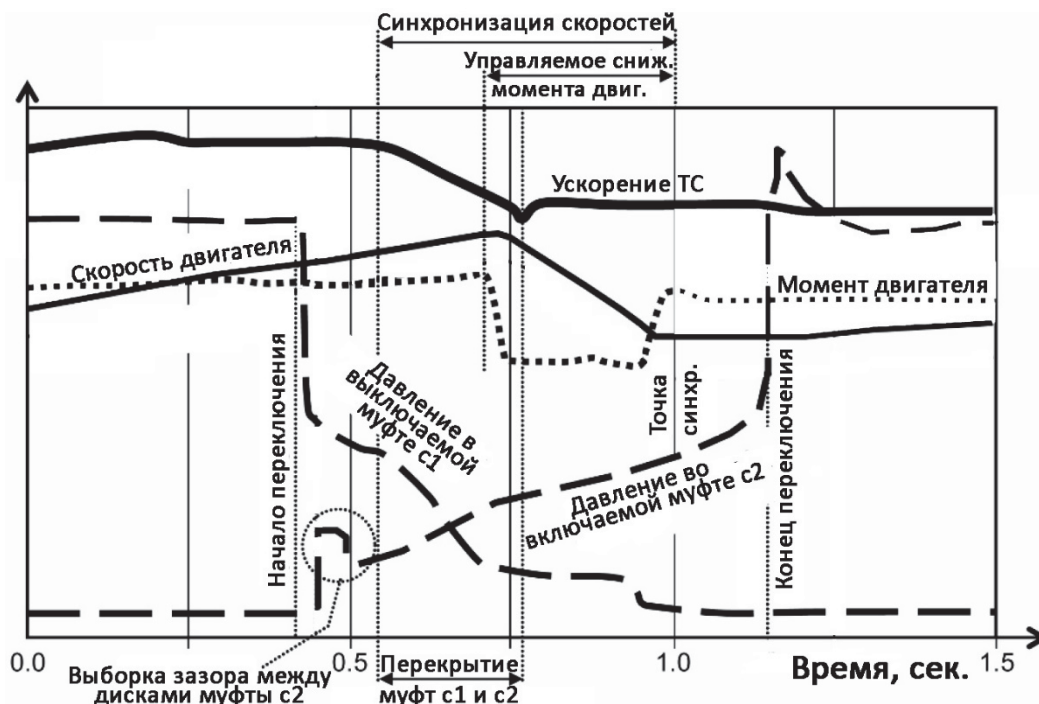
Рис. 3. Перекрытие муфт c1 и c2 при разгоне ТС.
