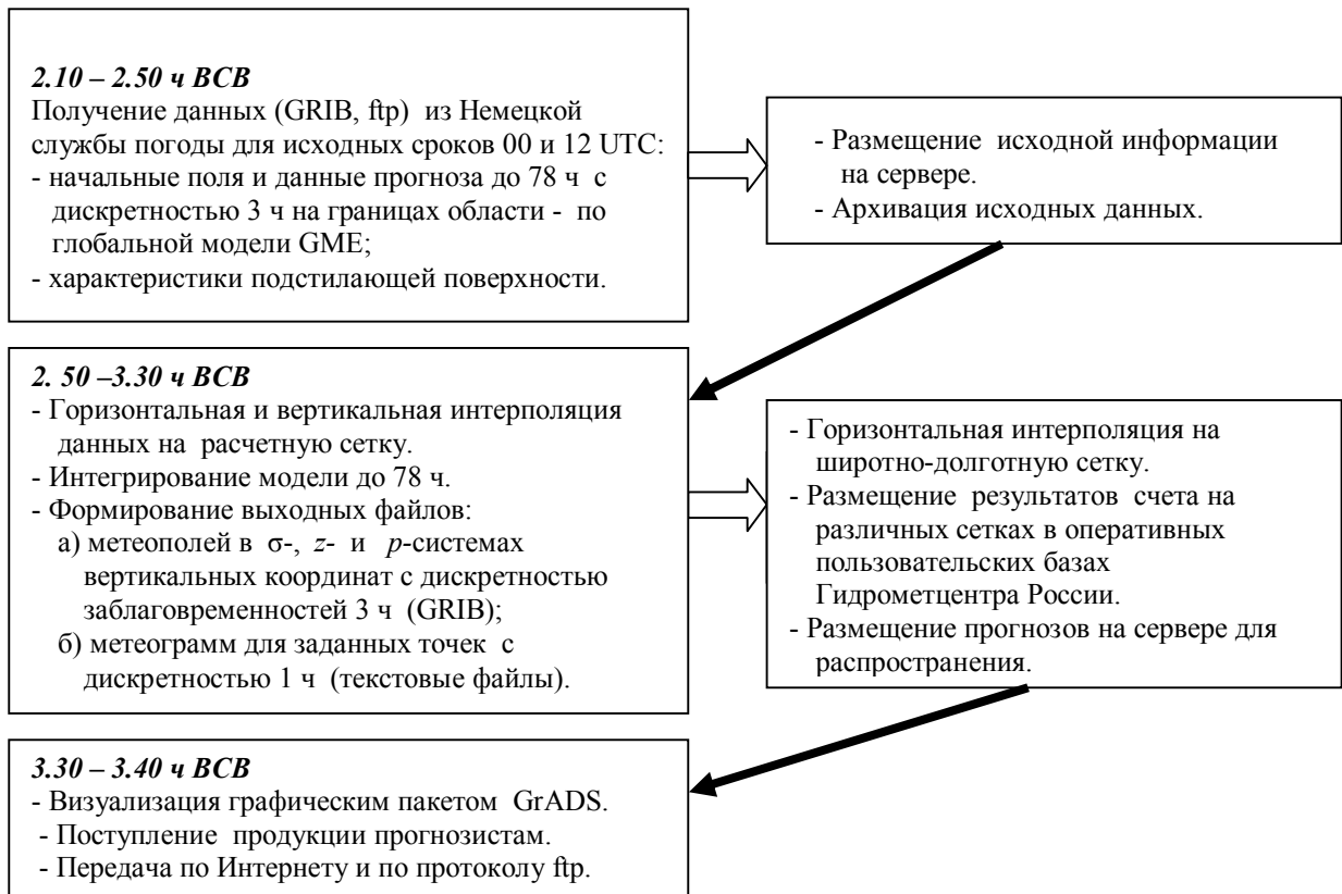
Рис. 2. Схема технологической цепочки выпуска численных прогнозов по модели COSMO-RU (по состоянию на 1 мая 2012 г.).
