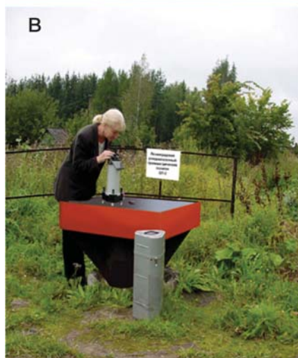
Рис. 3. Геофизические отраслевые эталоны, соподчиненные с государственными эталонами: а — передвижная установка (УКП-М) для калибровки магниторазведочной аппаратуры в полевых условиях; б — установка калибровочная трехкомпонентная (УКТ); в — гравиметрический поверочный полигон; г — стандартные образцы природных радиоактивных элементов U-238, Th-232, K-40
