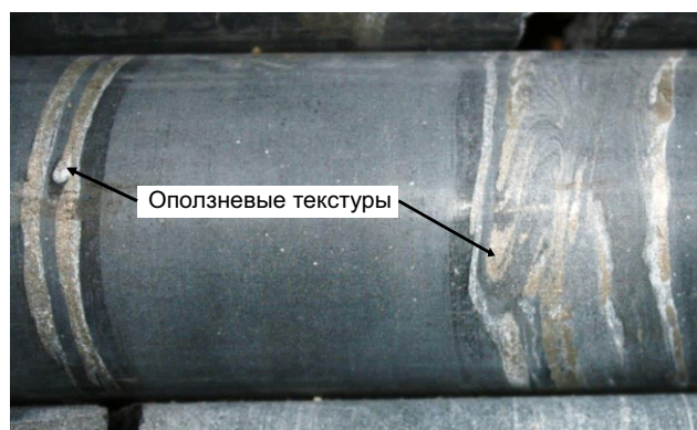
Рис. 4. Оползневые складки в существенно сульфидных слойках (жёлтые «блестящие»), сложенных пирротином. Месторождение Угаханское, бужуихтинская свита, скв. 8, инт. 109,8 м
