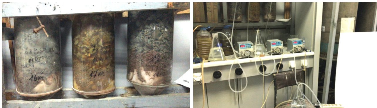
Рис. 4. Загруженные перколяторы для трёх вариантов выщелачивания
