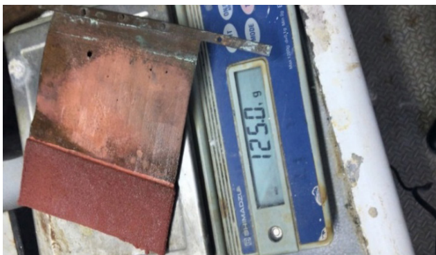
Рис. 8. Увеличение массы медного катода при электролизе с 94,2 до 125 г
