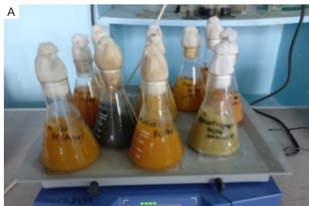
Рис. 2. Селекция и адаптация штаммов A. ferrooxidans к медному минеральному сырью:
