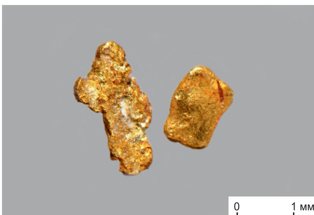
Рис. 9. Полуокатанные уплощённые сростки кристаллов золота из россыпи ближнего сноса с примазками глинистых минералов и локальными плёнками гидроксидов железа, с ямчато-бугорчатой или выровненной поверхностью. Невьянско-Аятская площадь Среднего Урала
