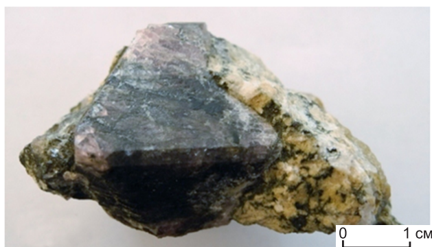
Рис. 1. Октаэдрический кристалл шпинели со слабо развитыми гранями куба в крупнозернистом агрегате форстерита с графитом:
