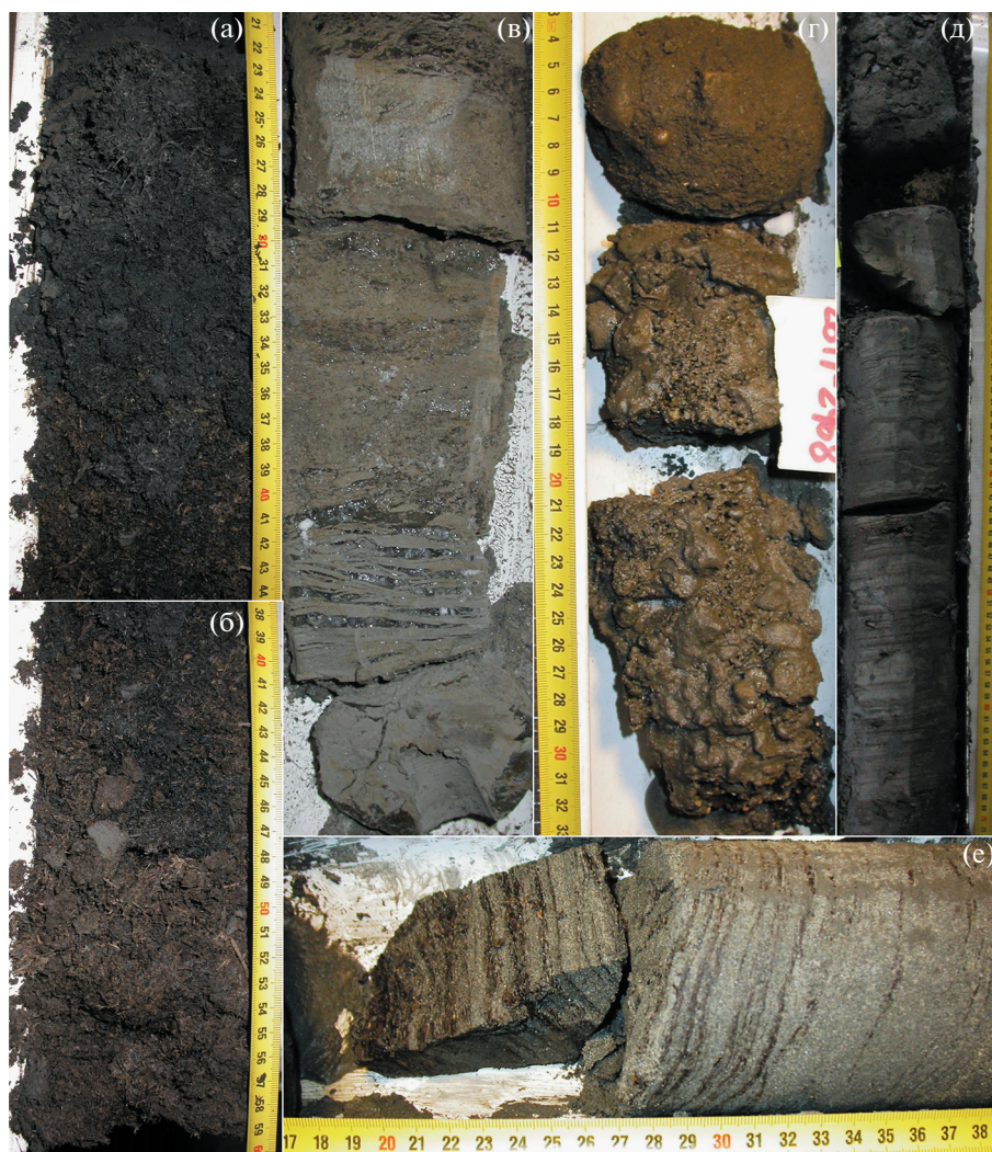
Рис. 3. Фотографии кернов из скважины 1D-14. (а, б) — фрагменты ферментированных мхов; (в) — шлировая криотекстура мерзлых отложений; (г) — гравийно-галечный слой; (д, е) — тонкослоистая наклонная структура (темные слои представлены древесными остатками).
