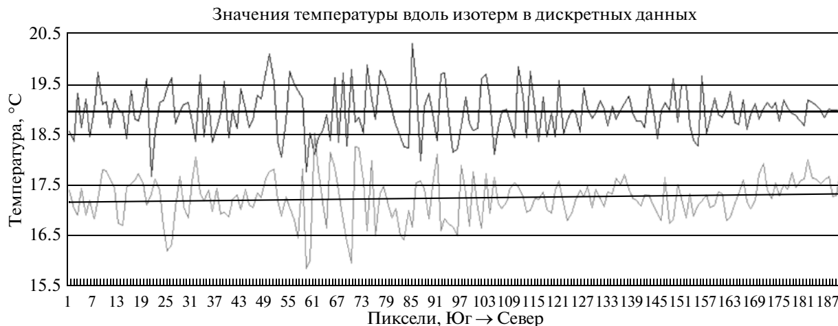
Рис. 4. Значения температуры вдоль изотерм 17.2 и 19°C. Линейный тренд показывает точность детектирования. Модельное поле ТПО за 2.05.2011 г. Разрешение – 14.98 км/пиксель.
