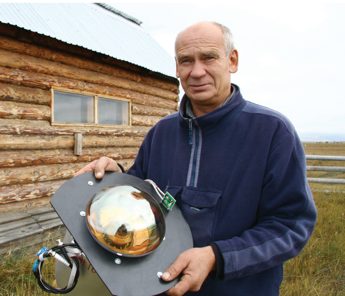
▲ Один из оптических детекторов установки Тунка-133 с новым приводом крышки
