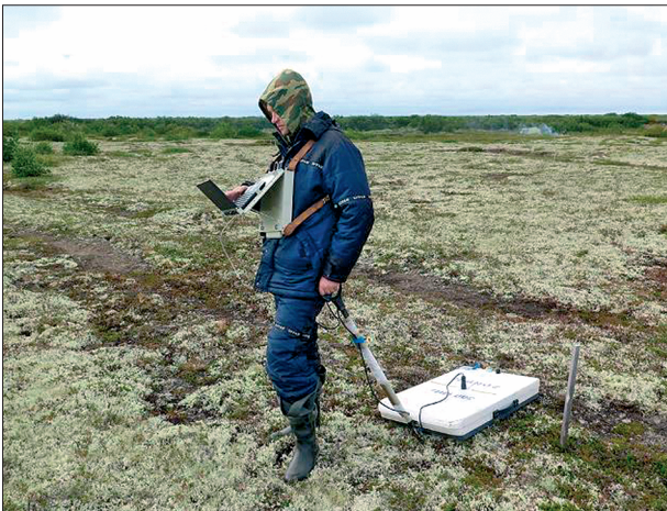
Рис. 3. Полевые георадиолокационные работы на участке Кумжа.
