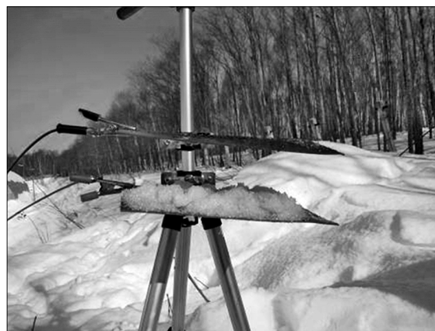
Рис. 4. Установка для экспериментов по электризации ледяных кристаллов в искусственном электрическом поле (фото Н.А. Казакова).
