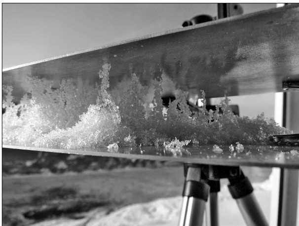
Рис. 7. Кластеры ледяных кристаллов вторично-идiomорфного снега, искусственно выращенные в электрическом поле (фото Н.А. Казакова).
