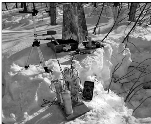
Рис. 4. Установка для экспериментов по электризации ледяных кристаллов в искусственном электрическом поле (фото Н.А. Казакова).
